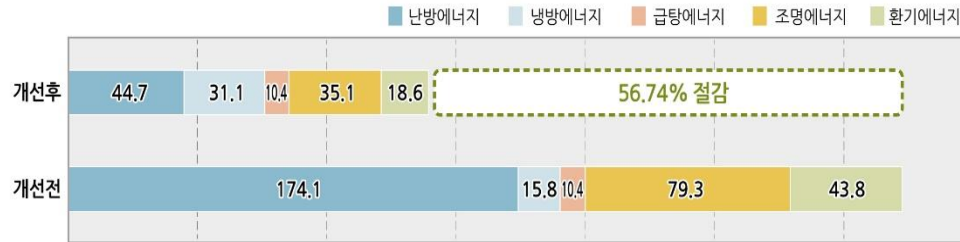
개선 전/후 에너지원별 절감비율 확인
